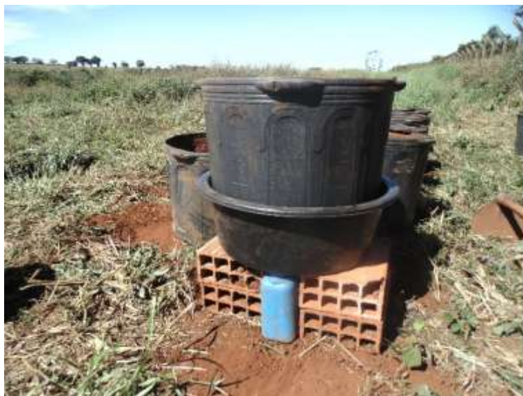
Figura 2 - Lisímetro de Drenagem
